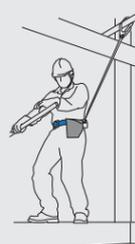
フルハーネス型は、胸ベルト型と比較して落下距離が長くなる傾向にあります。作業床の高さが6.75m以下で、墜落時に地面に到達する危険のある場合には胸ベルト型の使用が認められます。
