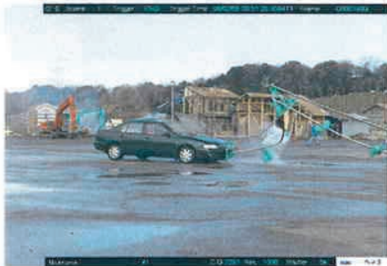
鉄製単管の場合（単管がフロントガラスに突き当たる）
